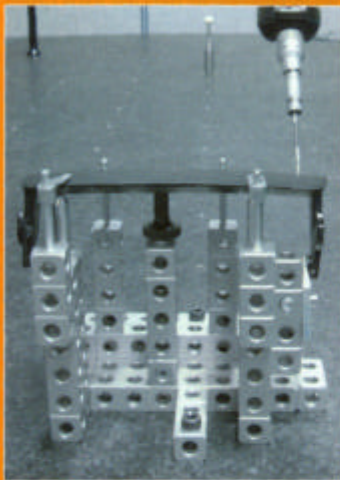
Abb. 2: Messung einer Blende für einen deutschen Automobilhersteller nach vorgegebenem Messpunkt-konzept
