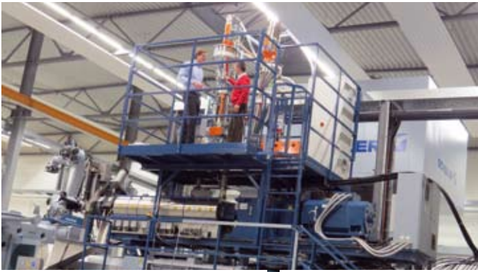
Der Spritzgießcompounder im acs verspricht besonders geringe Materialkosten bei der Herstellung von Kunststoffteilen.
